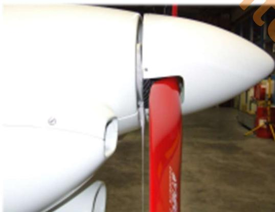
Abbildung 5: Befestigungspunkt zwischen Cowling und Propellerspinner
